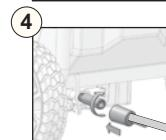
Conecte la manguera de alta presión al conector de desague.
